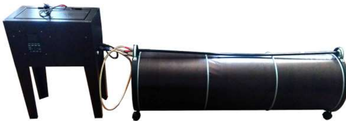
Рисунок 3 – Общий вид установки для обработки растительного сырья электромагнитными полями крайне низких частот
